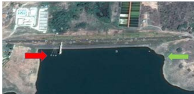
Figura 2: Vista superior da barragem de Pau dos Ferros, RN com indicação do ponto de captação do sistema de abastecimento de água do município (seta vermelha) e do ponto onde foi realizada a coleta da água para o presente estudo (seta verde).
